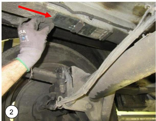
**NL** Plaats de klemplaat in het frame van het stootrubber.
