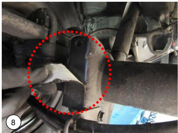
**NL** Dit is de locatie voor de onderbeugel, op het deel waar de stabilisatorstang normaal wordt geplaatst. Verwijder de tape indien aanwezig.
