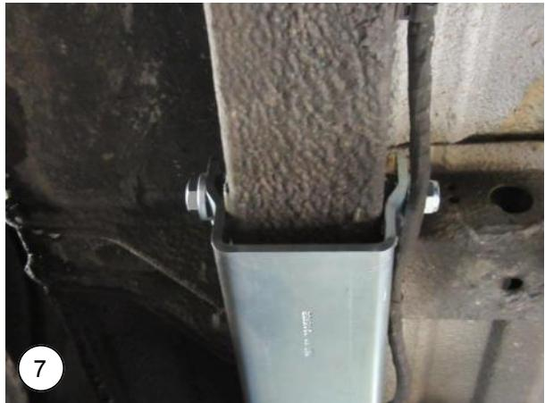
**NL** Zet de achterzijde van de bovenplaat vast met de M10x120 bout. **Uitvoeringen met stabilisatorstang:** Gebruik de originele bout.
