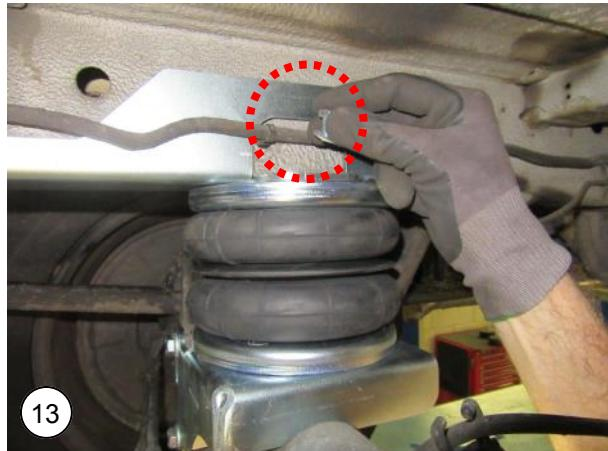
**NL** Let er bij het doorvoeren van de slang op dat deze niet beschadigd wordt of klemt. Zet nu de balg vast aan de bovenplaat.
