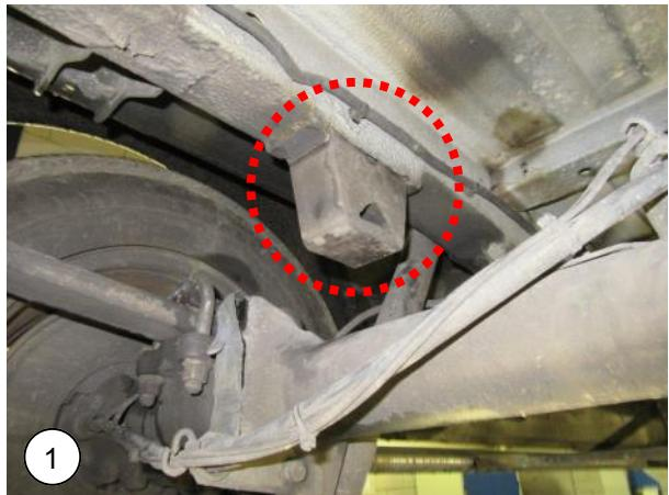
**NL** Verwijder beide aanslagrubbers van het chassis.
