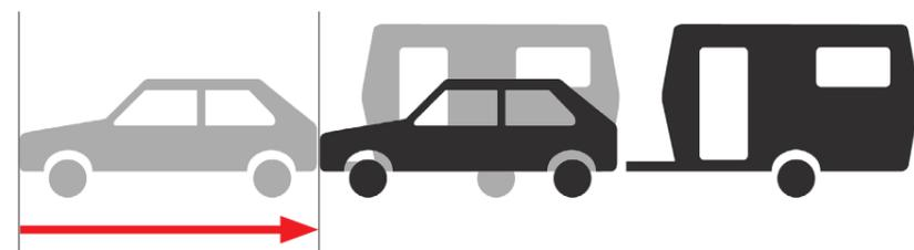
Par exemple : pour une voiture avec une caravane d'un PTAC de 1500 kg à une vitesse de 100 km/h, avec un mauvais réglage des freins, la distance de freinage est de 79 m.
