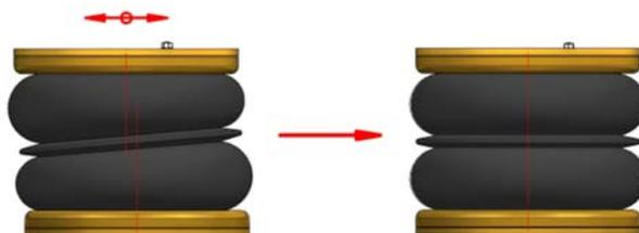
Déport axial si le coussin n'est pas aligné sur les supports
