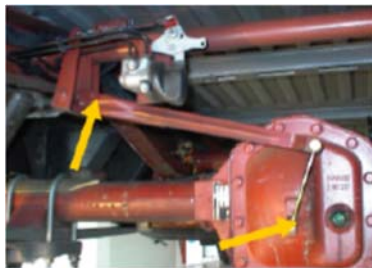
Photo 1 Démontage du bras de levier
