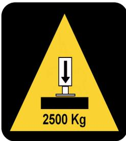
CHOISISSEZ UN POINT DE FIXATION CAPABLE DE SUPPORTER LE POIDS DES VÉRINS ET LA FORCE DE POUSSÉE DES VÉRINS POUR ÉVITER LES DOMMAGES. TOUS LES VÉRINS ONT UNE FORCE DE LEVAGE DE 2500 Kg!
