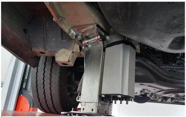
8. installare il piedino sulla staffa con il motore verso l'interno e rotazione verso il posteriore del veicolo
