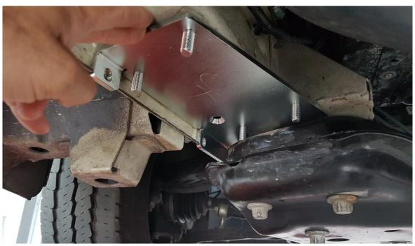
4. posizionare la staffa di fissaggio a battuta verso l'anteriore
