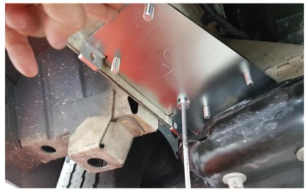
5. con l'aiuto di un piccolo cacciavite centrare la filettatura della contropiastra con il foro della staffa, quindi avvitare la vite di bloccaggio stringendo con forza.
