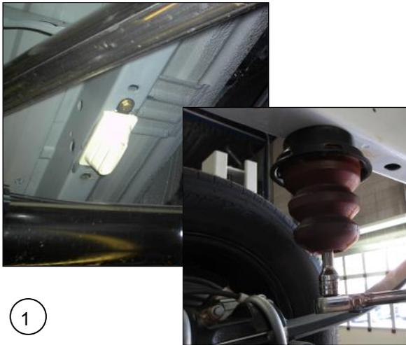
**NL** Verwijder beide aanslagrubbers van het chassis.
