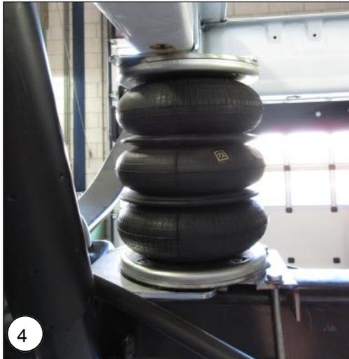
**NL** Lijn de onderplaat uit met de bovenplaat zodat de balg er recht tussen geplaatst kan worden. Als dit niet mogelijk is monteer de bovenplaat dan andersom!
