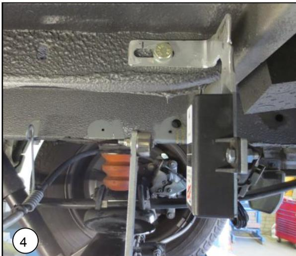
**NL** Zorg ervoor dat de sensor verticaal staat. (In lijn met de magneetsteun).
