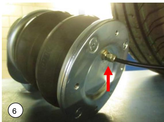
**NL** Bevestig de luchtslang aan de balg, zorg ervoor dat de onderplaat al stevig op de balg bevestigd is.
