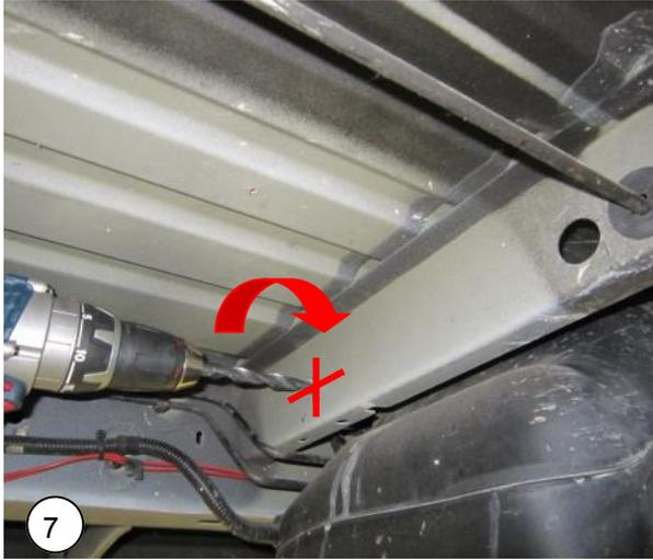
**NL** Boor ter plekke van de aftekeningen de gaten  $\varnothing 11$ -mm. Let bij de voorste chassisbalk op de achterliggende brandstoftank.
