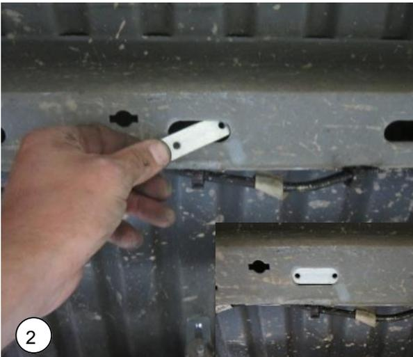
**NL** Plaats bevestigingsstrip van de sensor in het ovale gat van de chassisbalk boven de achteras.
